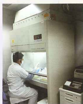
安全キャビネット(クラスII)で感染 症DNA検査の検体処理を行う
