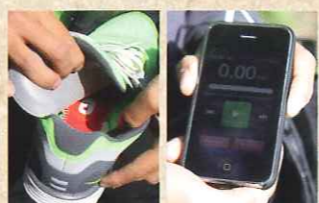
Nike+ランニングシューズに仕込まれたセンサーにより、ワークアウトデータをnikeplus.comに自動的に送信され、手持ちのiPhoneでチェックできる
